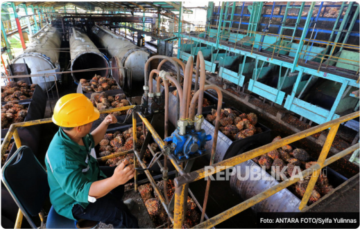
Karyawan memasukan tanda buah segar (TBS) sawit ke dalam mesin untuk pengolahan minyak sawit mentah atau crude palm oil (CPO) di salah satu pabrik Kaway XVI, Aceh Barat, Aceh, Jumat (21/7/2023).
